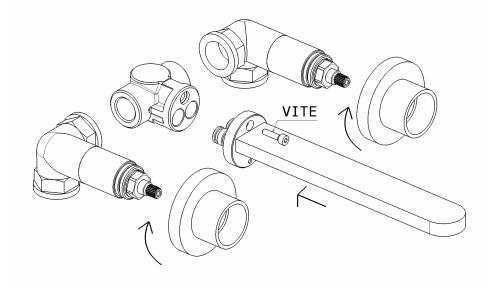
**3.** Applicare il rosone di copertura della canna portandolo a filo del rivestimento murario e fissarlo con la vite in dotazione. Applicare le leve sui vitoni ed avvitare il raccordo porta-aeratore sulla canna.
