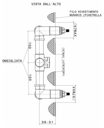
**2.** Inserire la canna con raccordi e fissarla nel corpo a muro tramite la vite in dotazione; avvitare i due raccordi copri-vitone, come indicato in figura.
