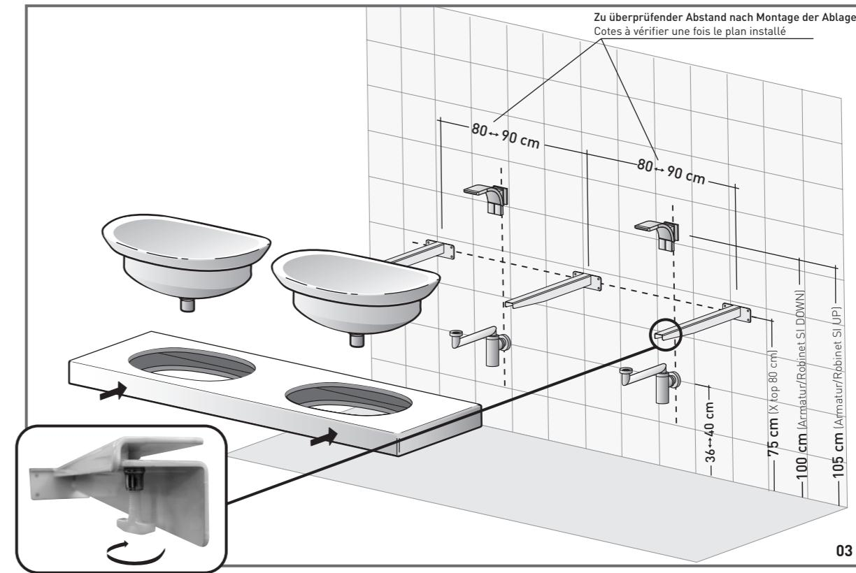
03\_art. I04275M2-3-4 2 Löcher/2 Percements: Nach Installation des Ablaues, befestigen Sie die 3 Stahlkonsolen, die im Lieferumfang enthalten sind. Benutzen Sie die Grundplatte der Konsolen als Schablone um die Bohrlöcher anzulegen. Schrauben Sie die Kunststoffschrauben am Ende der Konsole ein. Schieben Sie die Ablage auf die Konsolen und justieren diese mittels der Kunststoffschrauben.
