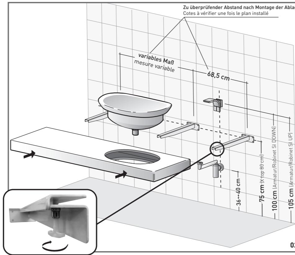
02\_art. I04275M2-3-4: Nach Installation des Ablaues, befestigen Sie die 2/3 Stahlkonsolen, die im Lieferumfang enthalten sind. Benutzen Sie die Grundplatte der Konsolen als Schablone um die Bohrlöcher anzulegen. Schrauben Sie die Kunststoffschrauben am Ende der Konsole ein. Schieben Sie die Ablage auf die Konsolen und justieren diese mittels der Kunststoffschrauben.
