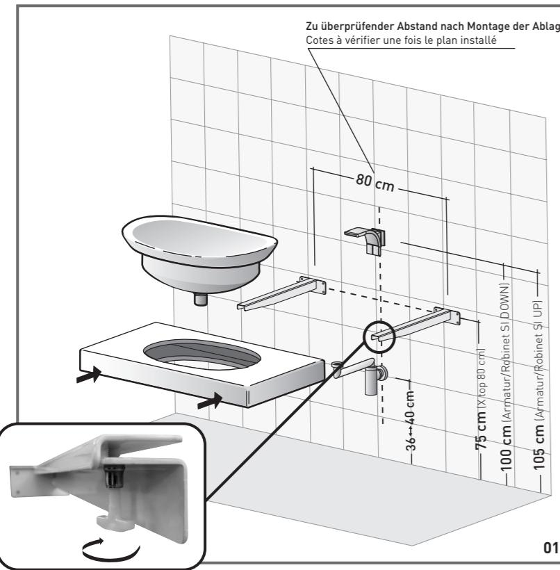
01\_art. I04275M1: Nach Installation des Ablaues, befestigen Sie die 2 Stahlkonsole, die im Lieferumfang enthalten sind. Benutzen Sie die Grundplatte der Konsolen als Schablone um die Bohrlöcher anzulegen. Schrauben Sie die Kunststoffschrauben am Ende der Konsole ein. Schieben Sie die Ablage auf die Konsolen und justieren diese mittels der Kunststoffschrauben.
