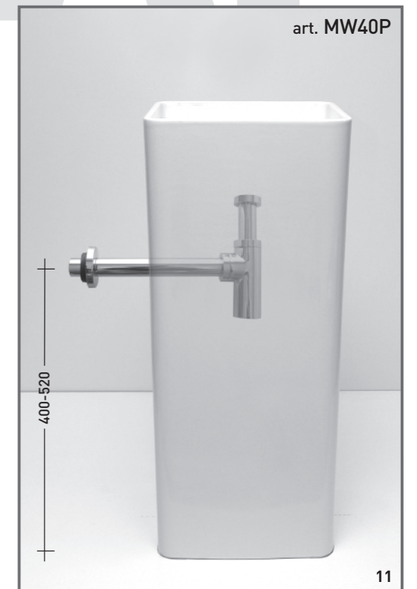
11 Monowash 40 mural, art. MW40P: pour le branchement de la sortie horizontale utiliser un siphon comme sur la photo. Monowash 40 Waschtischsäule Vorwandmontage Art. Nr. MW40P: Verbinden Sie den Ablauf mit einem wie hier dargestellten Syphon.
