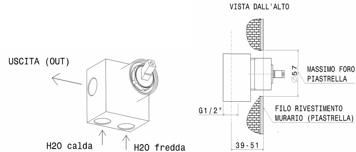
2. Completare l'installazione applicando la calotta, il rosone di copertura e la leva, come indicato in figura.
