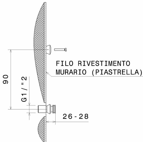
5. Installare la colonna doccia assicurandola agli ancoraggi a muro mediante i grani filettati, come indicato in figura.
