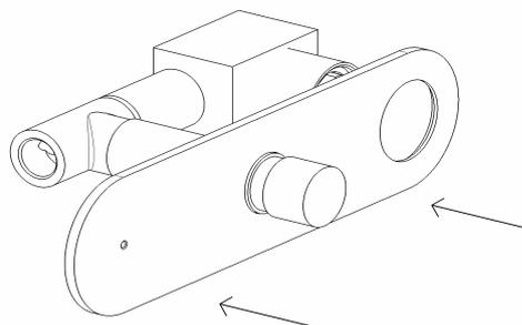
3. Installare il supporto porta-doccetta, avvitare il raccordo filettato sull'uscita del deviatore ed applicare calotta e leva sul corpo miscelatore, come indicato in figura.
