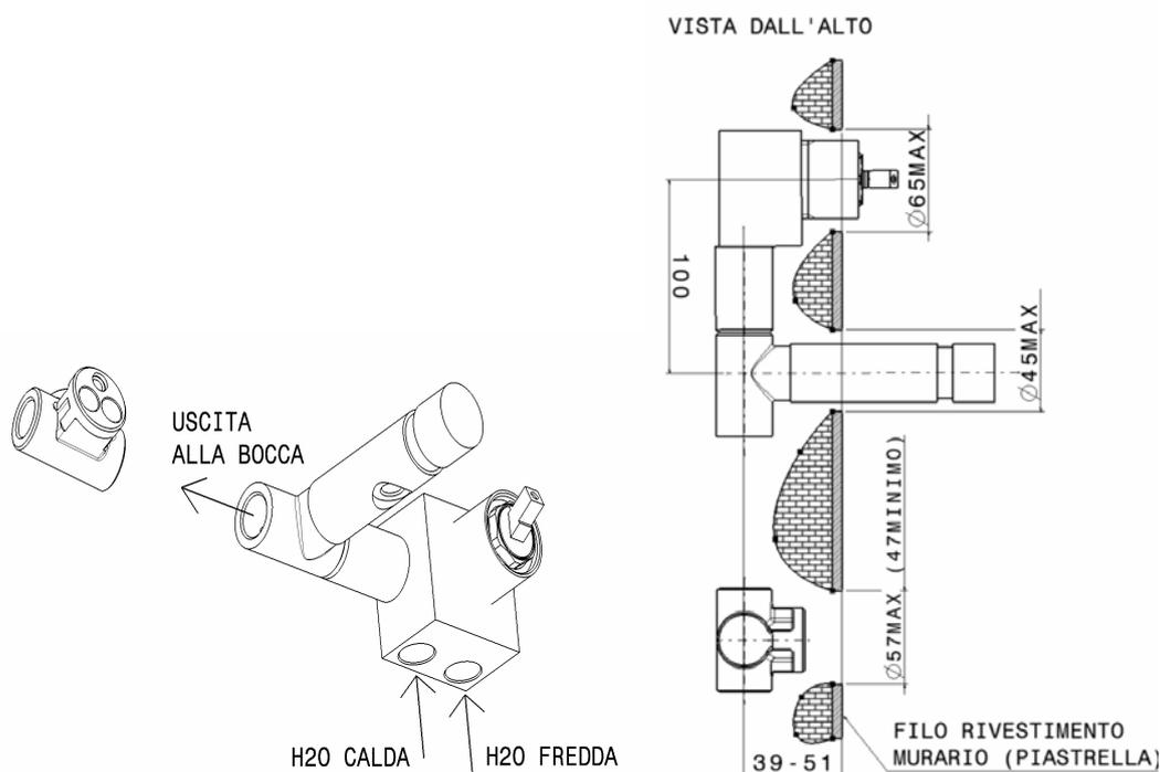
2. Applicare la piastra di copertura portandola a filo del rivestimento murario; inserire la canna con raccordi e fissarla nel corpo a muro tramite la vite in dotazione, come indicato in figura.
