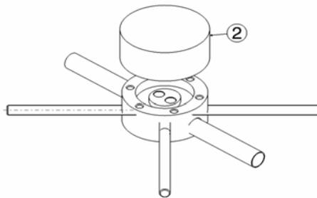
3. Stecken Sie die Armaturensäule auf den Flansch, richten diese mittels den mitgelieferten Schrauben aus und befestigen diese dann mit den restlichen Schrauben.
