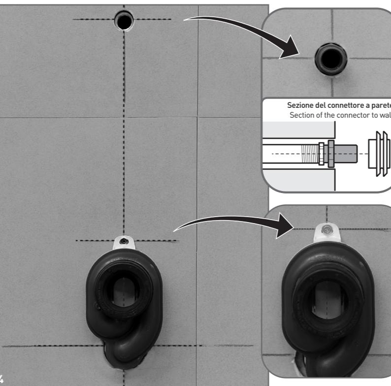
04 Installazione del sifone e del connettore. Avvitare il connettore di adduzione accertandosi che rimanga incassato nella parete, come da disegno. Collegare il sifone al morsetto di scarico; segnare la posizione del foro, utilizzando il sifone come dima. Quindi serrare la vite per allineare lo scarico al connettore di adduzione.
