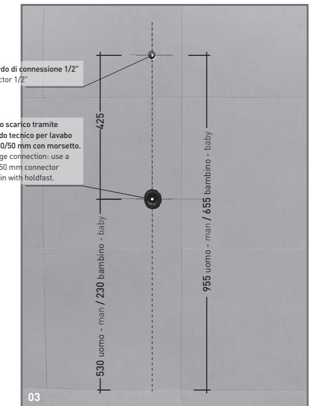
03 Predisposizione dello scarico e dell'adduzione acqua di risciacquo dell'orinatoio. Attenzione: rispettare le misure indicate.
