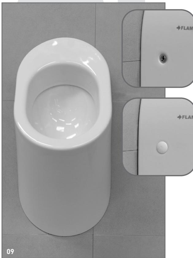
09 Installazione dell'orinatoio: montare il sanitario a parete, dopo aver ben lubrificato la guarnizione in gomma del sifone ed il morsetto. Bloccare il sanitario a parete come in figura.
