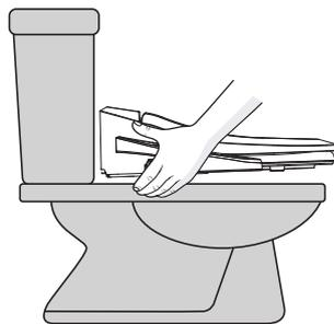
**4** Gerät hochhalten und Wasser gründlich abfließen lassen, durch Herausdrehen der Ablasschraube. (Aufpassen, dass die Ablasschraube nicht verloren geht).
