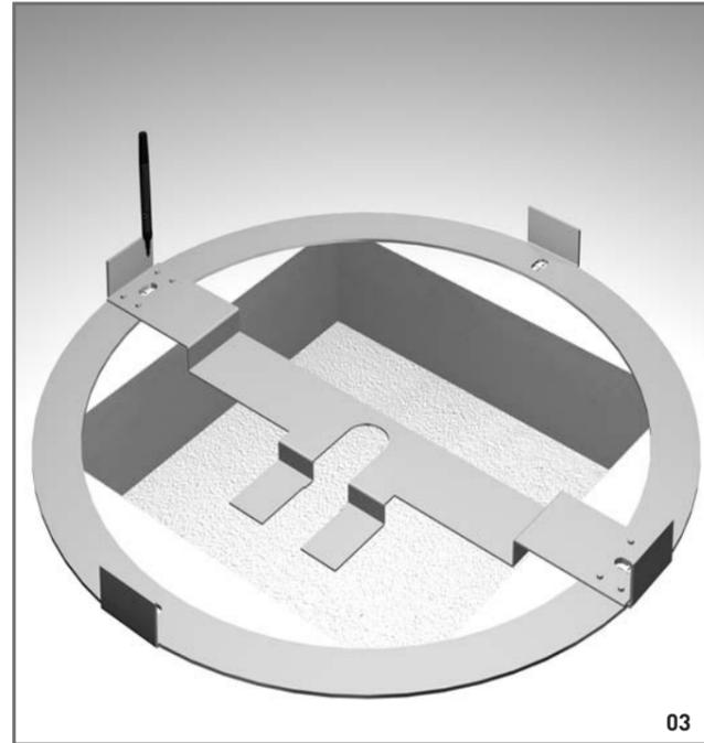
03 Positionieren Sie die beiliegende Schablone am Boden. Zentrieren Sie diese wie in der Zeichnung ersichtlich. Markieren Sie mit einem Stift die Löcher in der Schablone am Fußboden.
