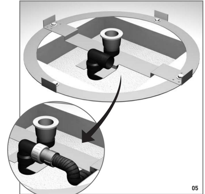
05 Positionieren Sie den mitgelieferten Syphon auf der dafür vorgesehenen Halterung. Stellen Sie die Verbindung zwischen dem Syphon und der bauseitig vorhandenen Ab- laufleitung her. ( Am besten mittels Flexanschlußschlauch )
