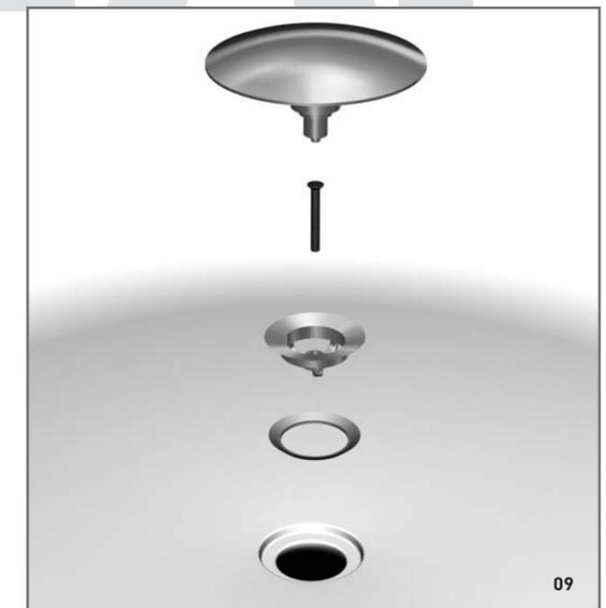
09 Nehmen Sie das Ablaufventil, dichten dieses ein und platzieren Sie es im Ablaufloch der Wanne . Drehen Sie nun die Schraube in das Unterteil des Syphon fest ein. Nehmen Sie den Excenterstopfen und bringen diesen in die dafür vorgesehene Öffnung ein. Drückend schließt / öffnet der Excenterstopfen den Ablauf. ( Klickventil )
