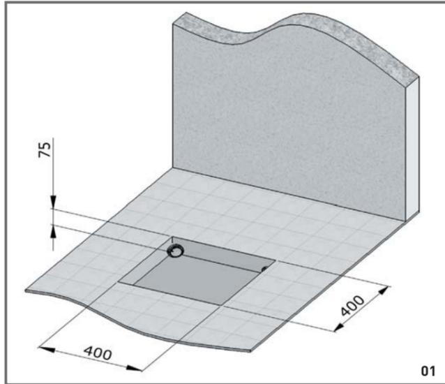
01 Vorbereitung der Aussparung im Boden für den Ablauf
