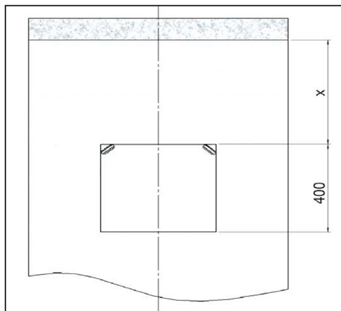
**PREPARAZIONE DEL PAVIMENTO:** predisporre uno scasso nel massetto per alloggiare il sistema di scarico, rispettando le misure indicate in figura. Le quote sono da intendersi a pavimentazione ultimata. La quota X è indicativa e dipende da come si vuole installare la vasca. Con X=47,5 cm (misura minima) la vasca Fontana è a filo con la parete. Posizionare un tubo di scarico Ø40 mm come illustrato (la direzione dello scarico può essere destra o sinistra).
