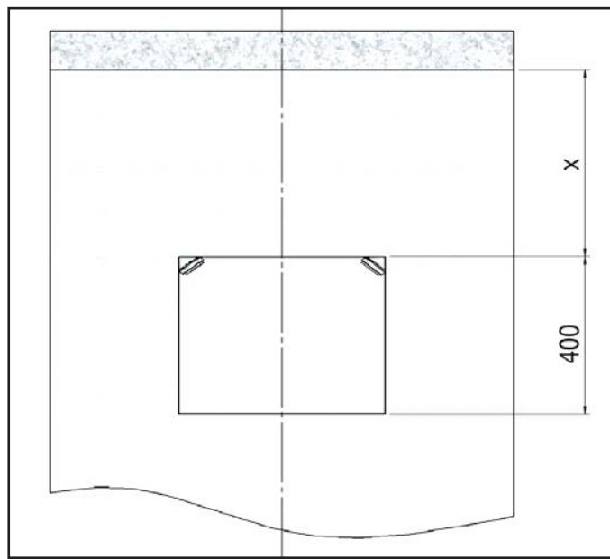
**VORBEREITUNG DES BODENS:** Stellen Sie für die Vorbereitung des Ablaufes, nach Einbringen des Estrich, eine Aussparung, mit den in der Skizze angegebenen Maßen, im Boden her. Führen Sie den Ablauf wie in der Skizze beschrieben in die Aussparung ein. Das Ablauftrohr kann links oder rechts platziert werden.
