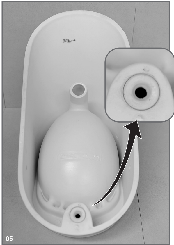
05 Vorbereitung zur Befestigung des Urinal: Bringen Sie den Gummiverbinder in das vorbereitete Loch ein. Installation de l'urinoir: Insérer l'étrier en caoutchouc dans le support approprié.
