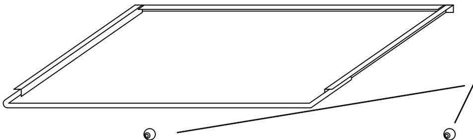
4.) Befestigen Sie die beiden konischen Halterungen an der Wand , nachdem Sie deren exacte Position bestimmt haben.
