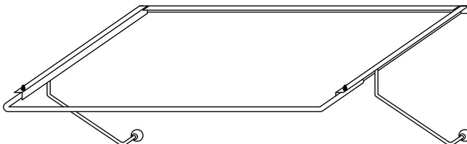
6.) Nachdem Sie die Glasplatte aufgelegt oder das Waschbecken eingesetzt haben , können Sie das Niveau mittels den Schrauben unterhalb der Konsole regulieren.
