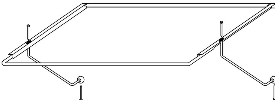
5.) Bringen Sie die Halterungen in die dafür vorgesehenen Löcher in der Konsole und in den konischen Halterungen und befestigen diese.
