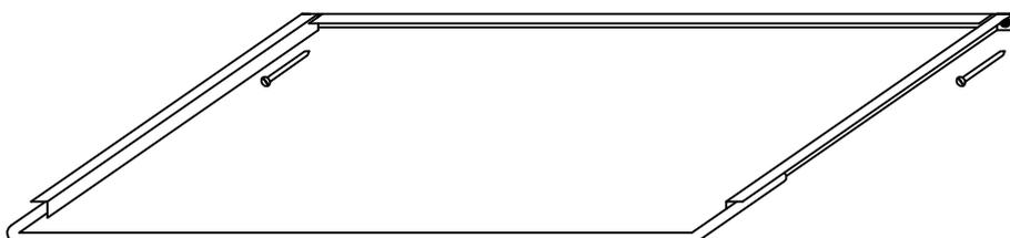
3.) Schieben Sie den Handtuchhalter mit den Trägern auf das Winkelprofil und befestigen diese an der Wand.
