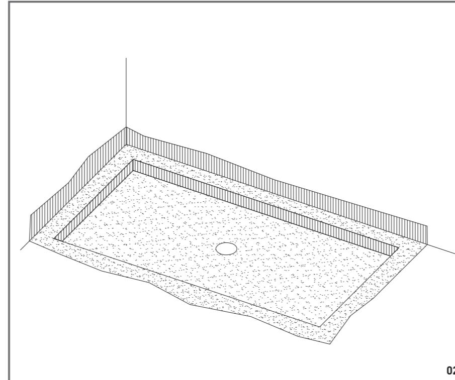
02 Pour éviter les infiltrations d'eau, il faut mettre deux couches de produits d'étanchéité (par exemple Rasolastik ou similaire), sur toute la surface de la chape et déborder un peu.
