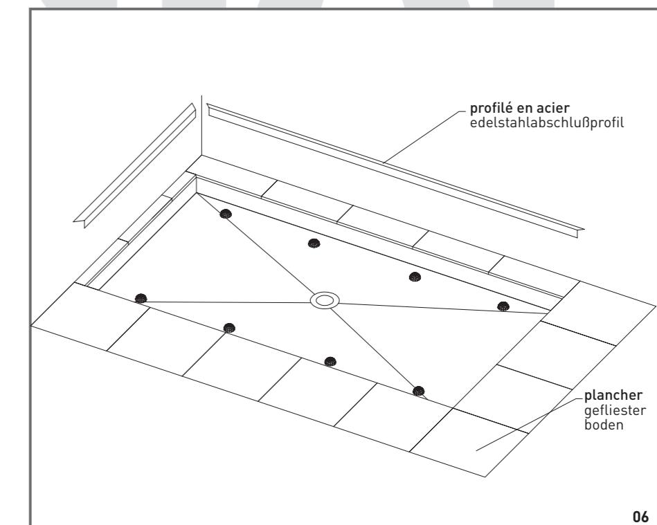
06 La mise en place du profilé en acier sur le bord du receveur de douche est facultatif, il est t suggéré quand les coupes du carrelage ne sont pas parfaite. Die Verwendung unseres Abschlußprofiles aus Edelstahl ist optional empfehlenswert, wenn die Fliesenränder uneben oder unansehlich sind.
