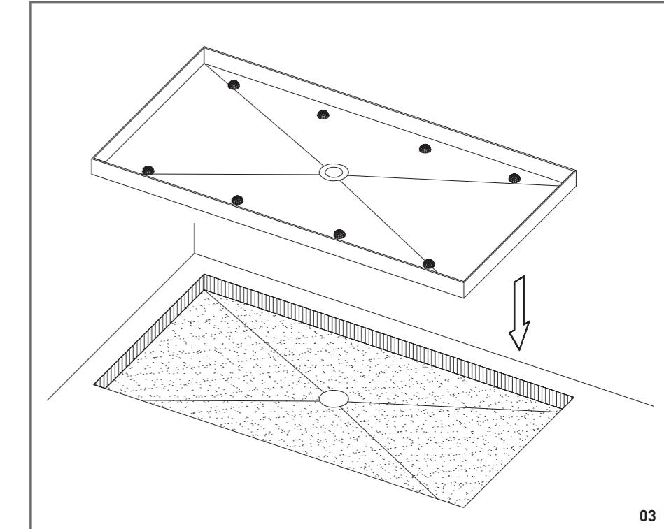
03 Pour assurer une parfaite adhèrence entre le receveur et la chape, étendre une colle à base de polyrèthane (par exemple Super Flex Kerakoll ou similaire) dans la zone réservée au receveur douche sur une épaisseur variable jusqu'à 10 mm compenser la pente des bords vers le centre. Streichen Sie die Unterseite des Grundmodules mit Zweikomponenten Kleber Vollflächig ein.
