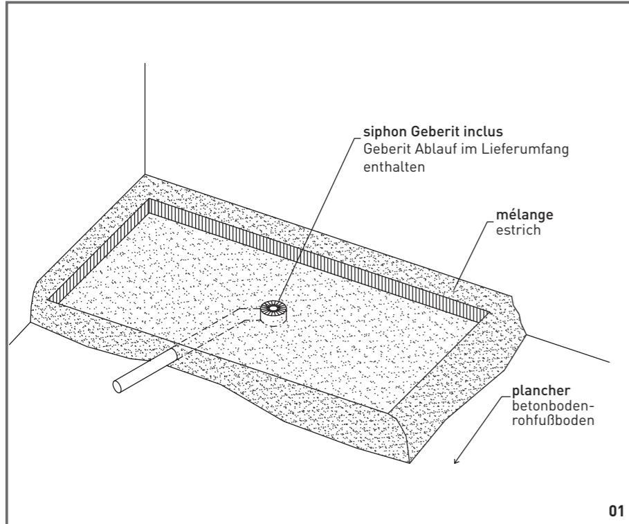
01 Préparer la sortie du receveur et relier le siphon inclus; puis déverser le mélange (sable, ciment) dans la chape en noyant les tuyaux d'évacuation ainsi que le siphon.
