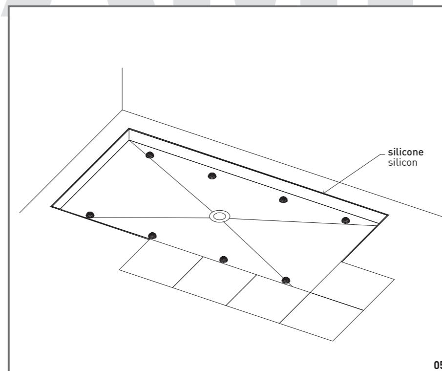
05 Procéder à la pose du carrelage qui doit couvrir le bord du receveur, puis mettre du silicone entre ce bord et le carreau afin d'optimiser l'étanchéité. Fahren Sie mit der Installation des Bodenbelag fort (Dieser muß die Kanten des Grundmodul überdecken!) und dichten Sie das Grundmodul zu den Fliesen hin ab.
