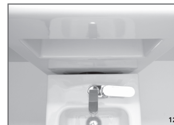
11-12 Installazione del complemento Niagara: allontanare leggermente il bidet dalla parete (140 mm), senza far uscire il tubo dal morsetto; rialloggiare il complemento Niagara dall'alto verso il basso, spingere il bidet contro il complemento ed infine fissarlo a terra. Non usare silicone per sigillare bidet e complemento. Niagara panel installation: carefully pull the bidet away from the wall at 140 mm, paying attention to the pipe; hook up the Niagara panel from the top towards the bottom, push the bidet against the panel and then fix it to the floor. Do not use silicone to seal bidet and panel.
