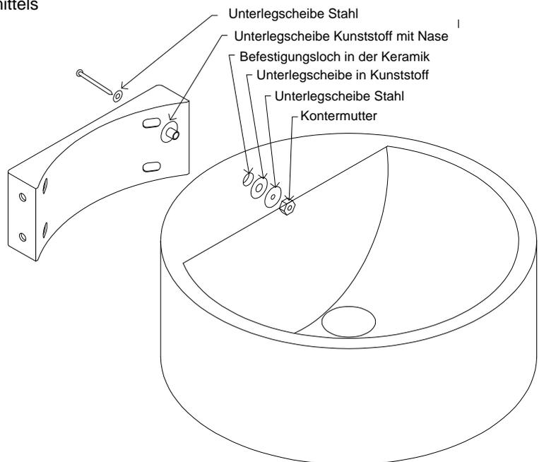
Befestigen Sie das Becken an der Konsole
