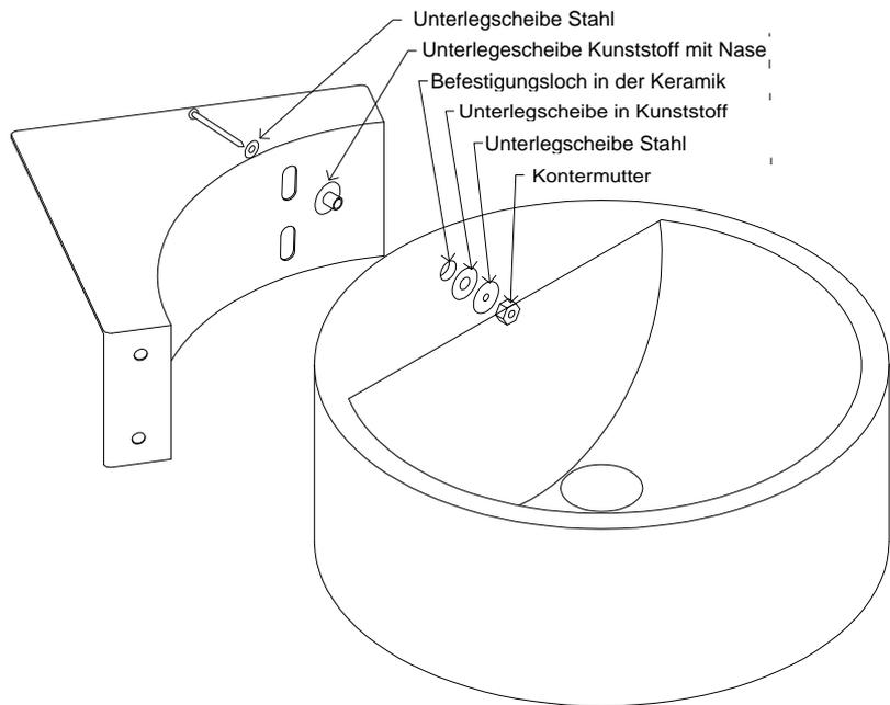
Befestigen Sie das Becken an der Konsole mittels den mitgelieferten Schrauben.
